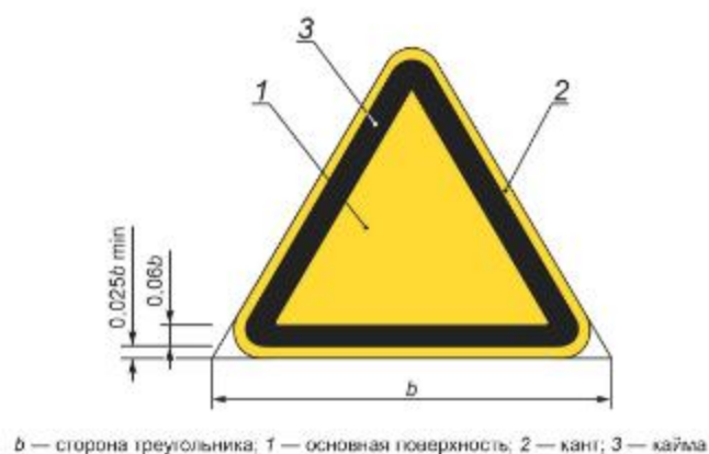
Рисунок 2 - Основа цветографического изображения и соотношение размеров предупреждающих знаков безопасности
